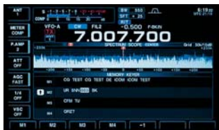
Mini scope function example • Frequency (top) • Mini scope (middle) • Memory keyer setting (Bottom)
